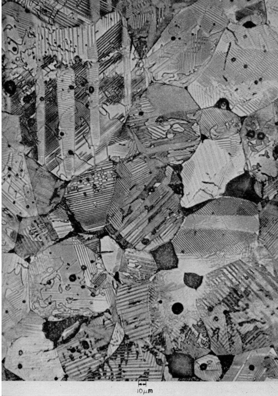
Abbildung 3: Sichtbare Domänenstruktur eines BaTiO 3 Gefüges durch Ätzung der polierten Oberfläche [3]
