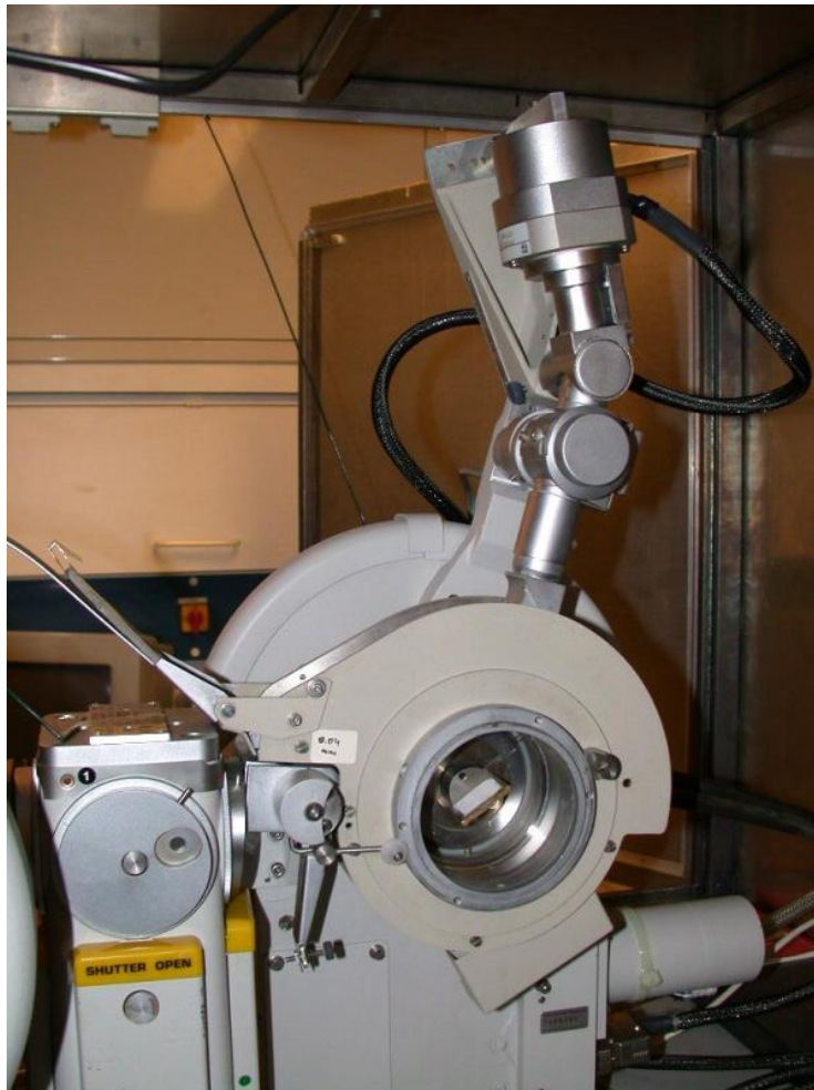
Abbildung 30: Das X'Change Pulverdiffraktometer mit Sekundärmonochromator
